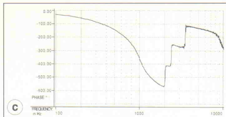
Bild 3. Meßergebnisse für Kemo VBF8: a) Klirrfaktor über dem Pegel, b) Frequenzgang, c) Phasengang, d) Impulsantwort.
